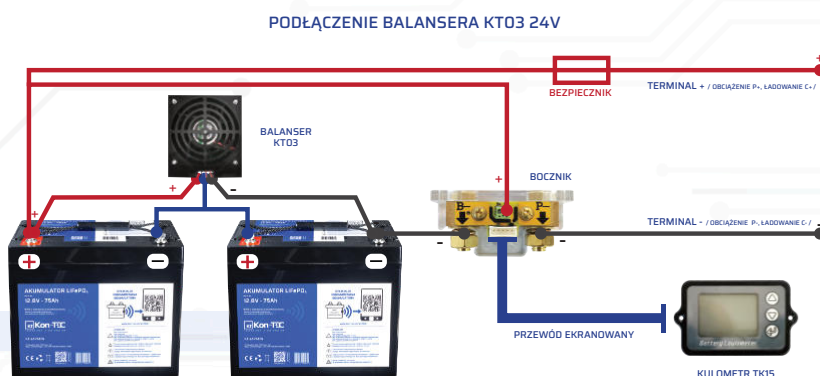
Rys.3. Schemat szeregowego połączenia akumulatorów
