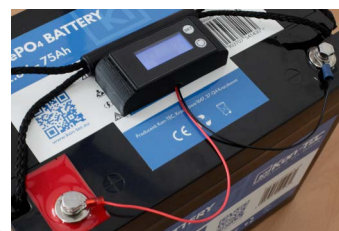
5. Podłącz kable do akumulatora.
