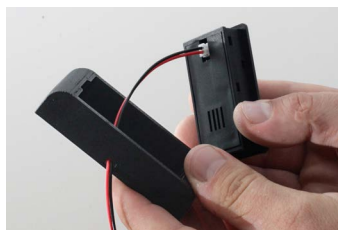
2. Kabel przeciągnij przez otwór w obudowie
