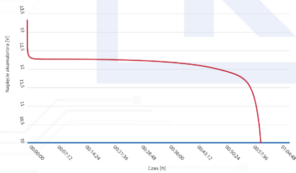
Rys. 1 Spadek napięcia na akumulatorze, rozładowanie 1C
