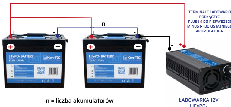
Rys.2. Schemat podłączenia pojedynczego akumulatora
