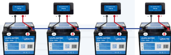
Podłączenie stabilizatora w akumulatorach połączonych w szereg
