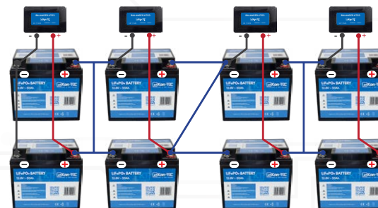
Podłączenie stabilizatora w akumulatorach połączonych równolegle
